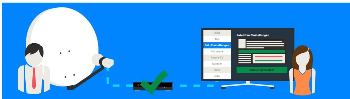
Zur Signalsuche können Sie auch ein digitales Satellitenmessgerät verwenden. Verbinden Sie dieses über Kabel mit dem LNB, zeigt es Ihnen die Signalstärke des benötigten Satelliten an.
